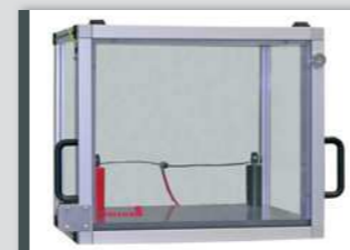
Test cage 30KV
